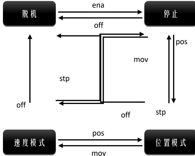
※ 模式内的目标速度或者目标位置变化，停止、速度模式以及位置模式模式之间的切换，只要是当前速度跟目标速度不一致，或者位置方向与速度反向，都会自动启动加减速，平滑运转到目标速度或者目标位置。整个过程都会进行平滑的加减速运动，避免急停或者突然转向。并且在整个运动过程中，电流会根据当前的运行状况自动匹配，让扭矩，噪声以及电机发热得以很好的控制。
